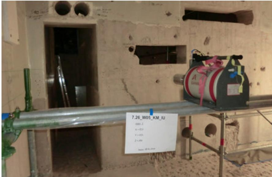
Abbildung 10: In-situ-Gammaspektrometer bei der Entscheidungsmessung von Gebäuden (Brenk Systemplanung GmbH)
