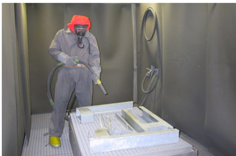
Abbildung 9: Mediumstrahlen von metallischen Komponenten
