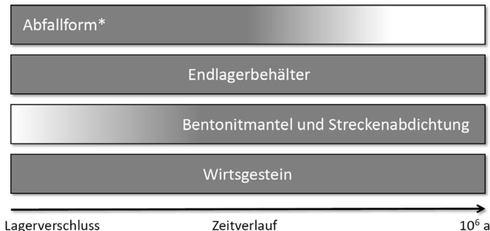
Abbildung 6.2: Wesentliche Barrieren und deren erwarteter prinzipieller Wirkungszeitraum in Kristallingestein gemäß schwedischem KBS-3-Konzept [4]. Der Schattierungsverlauf entspricht keiner exakten Lebensdauer der Barriere, sondern soll lediglich einen Trend andeuten (dunkle Schattierung bedeutet Wirksamkeit).
